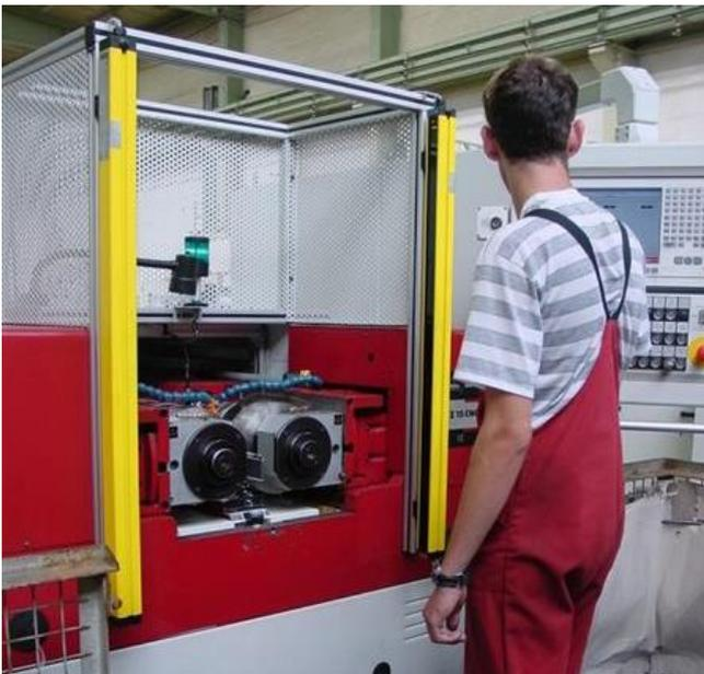
Bild 4: Aktive optoelektronische Schutzeinrichtung (AOPD) an einer Verzahnungs-Rollwalzmaschine
