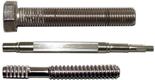
Bild 2: Quasi-rotationssymmetrische Werkstücke ohne ausgeprägte Fangstellen
