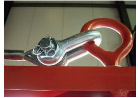
Abb. 11: Nur mit Werkzeug lösbar – Schäkel gerade Form mit Mutter und Splint
