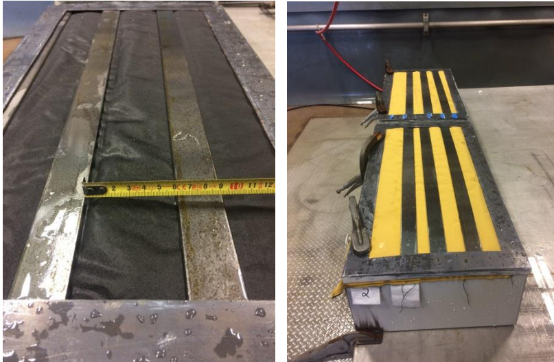
Bild 10: Prüfaufbau / Prüfmusterhalterung mit Metallträgern zur Justierung der Prüfmuster
