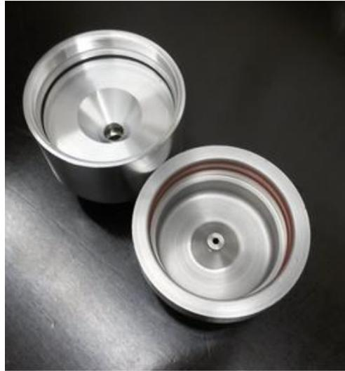
Abbildung 8 Einlasskappe der optimierten (links) sowie der herkömmlichen Denuderkartusche (rechts).
