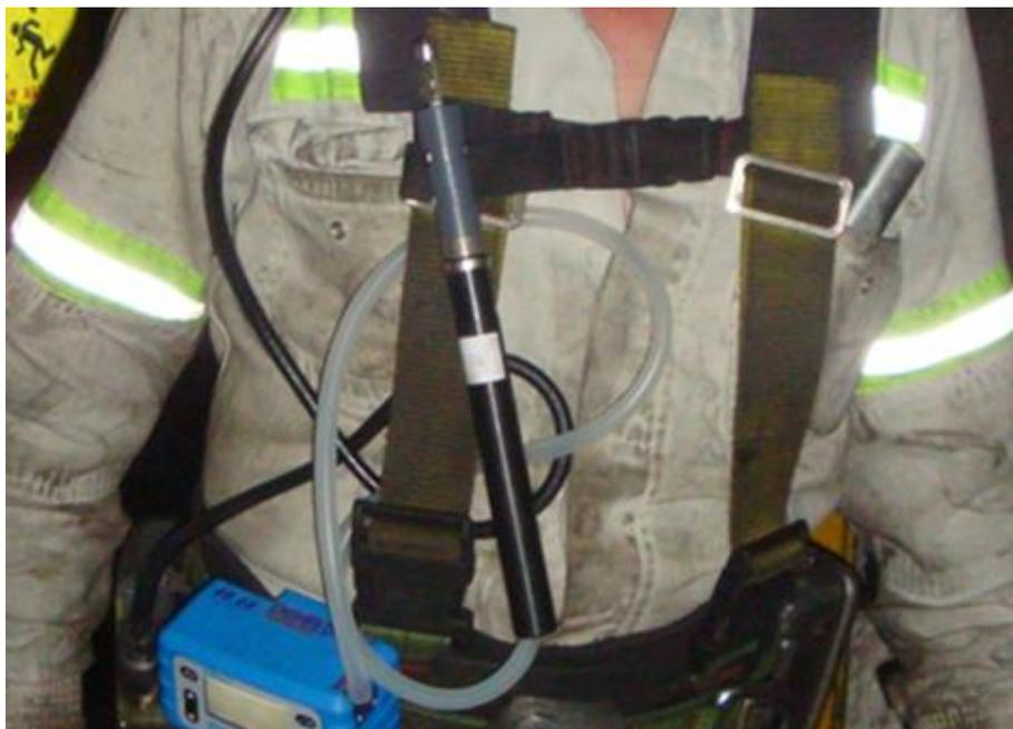
Abbildung 27 Minenarbeiter mit einem Aerosolsammler und einer tragbaren batteriebetriebenen Pumpe.
