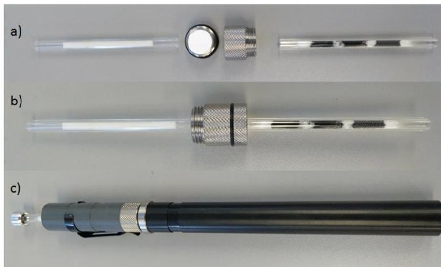
Abbildung 26 Personengetragener Aerosolsammler a) demontiert, b) zusammengesetzt, c) zusammengesetzt mit Einlass sowie Schutzgehäuse.
