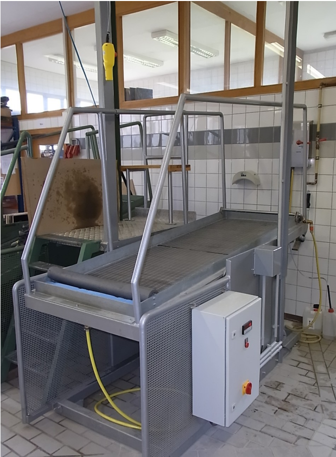
Abbildung 2: Schiefe Ebene nach DIN 51097
