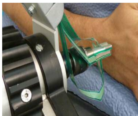
Abbildung 7: Stößel mit aufgeklebter Druckmessfolie
