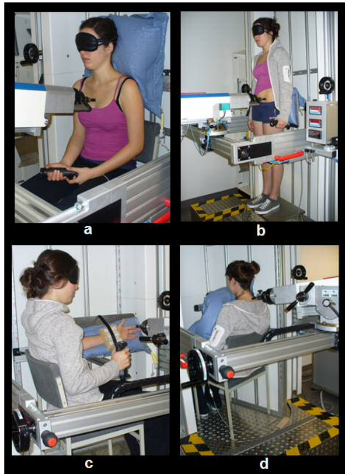
Abbildung 5: Lagerungshilfen für Messungen (a) am Brustbein, (b) Beckenknochen, (c) an der Fingerbeere, (d) am Halswirbel
