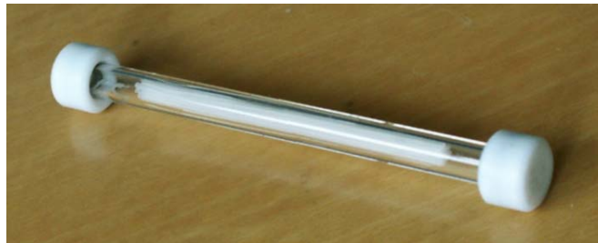
Abbildung 10 Multichannel Absorber-Denuder in Thermodesorptionsröhrchen für PE ATD 400
