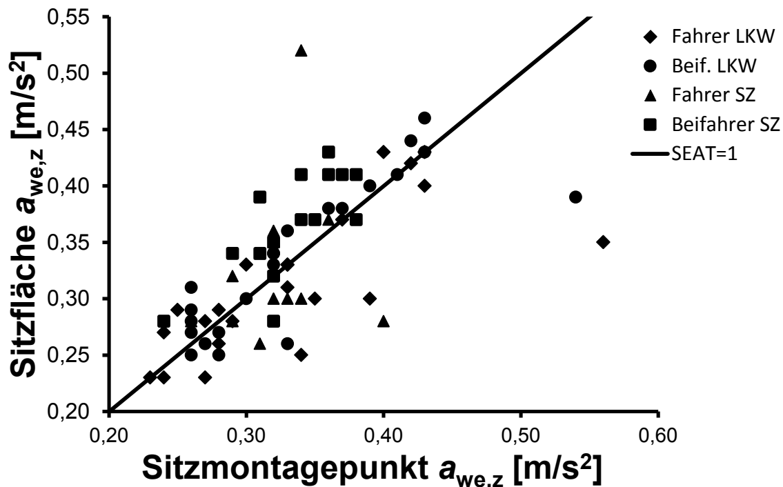
Bild 2: Energieäquivalente Mittelwerte der frequenzbewerteten Beschleunigungen in z-Richtung auf der Sitzfläche als Funktion derselben Messwerte am Sitzmontagepunkt: Datenpunkte, die auf der schwarzen durchgezogenen Linie liegen, entsprechen einem SEATz = 1,0. Datenpunkte über dieser Linie bedeuten, dass der Sitz die Schwingungen in z-Richtung verstärkt. Datenpunkte unter dieser Linie bedeuten, dass der Sitz die Schwingungen in z-Richtung dämpft.
