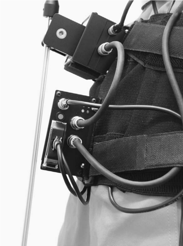
Abbildung 17 b: Datenlogger von der rechten Seite – Verkabelung
