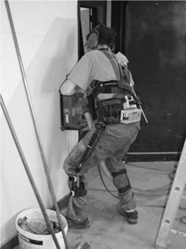
Abbildung 15 a: CUELA-System am Proband bei der Arbeit – Basisversion
