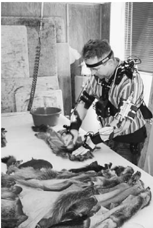
Abbildung 37: Anfeuchten und Aufzwecken der Felle
