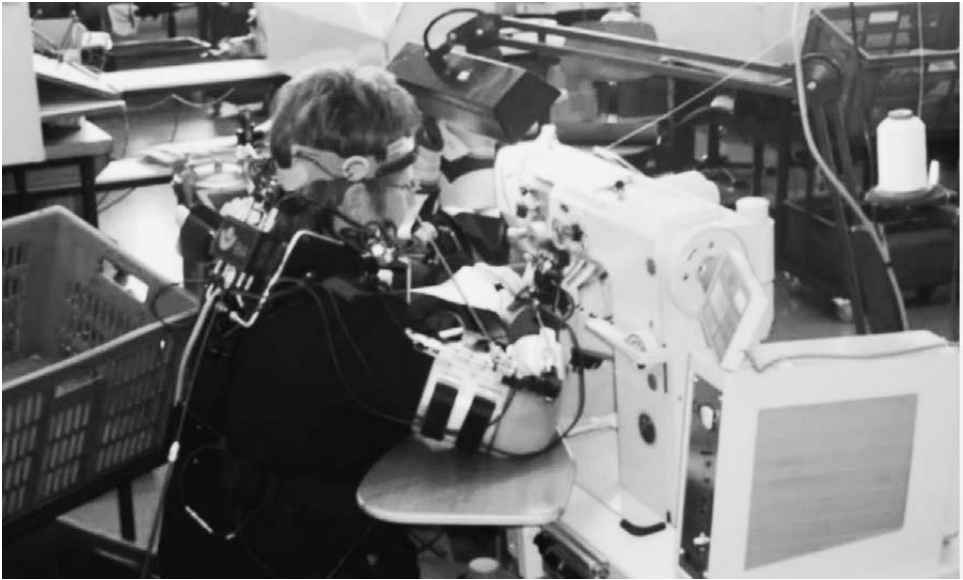
Abbildung 15 b: CUELA-System am Proband bei der Arbeit – erweiterte Version
