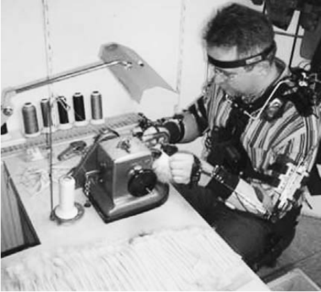
Abbildung 38: Arbeit an der Pelznähmaschine; links: im Vordergrund vorbereitete Streifen, rechts: „Einstreichen“ der Fellhaare mit der Pinzette
