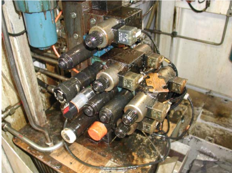
Abbildung 49: Hydraulikanlage des Bearbeitungszentrums nach Ausfall der Ventile
