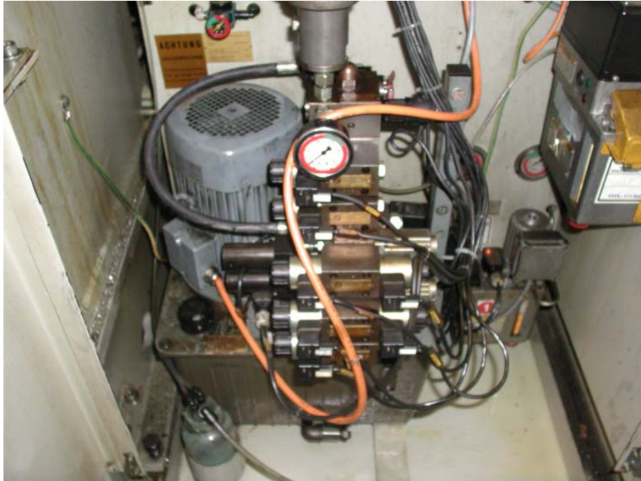
Abbildung 56: Rücklauffilter mit elektrischer Überwachung und Schnellkupplungstellung
