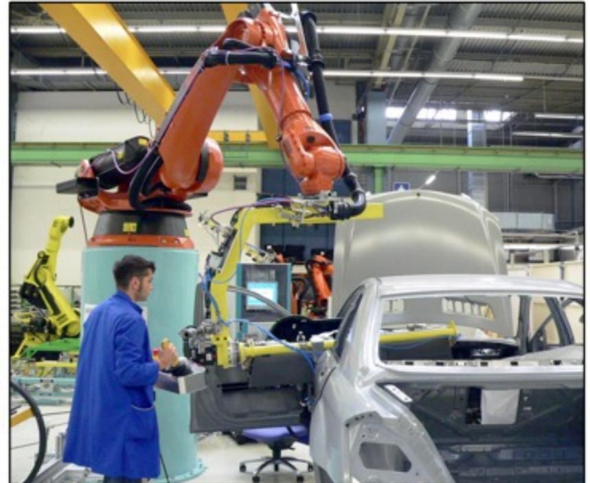
Abb. 1: Kollaborierender Montageroboter (Roboteranlage „Teachen“)
