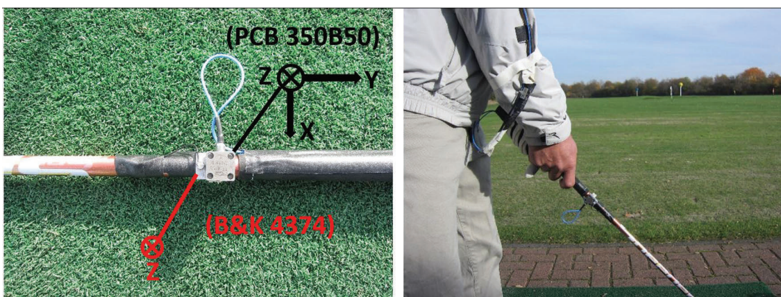
Bild 5 Hauptversuch – Anbringung der Sensoren, Messrichtungen und Handhaltung beim Golfschläger B.
