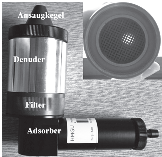
Bild 1. Modifizierter GGP-Sammler (angefertigt in der Werkstatt des Helmholtz Zentrums München) mit integriertem Denuder (Denuderquerschnitt oben rechts) zur Dampf/Partikel-Trennung von SVOC-Aerosolen [17].
