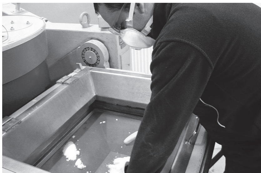
Bild 1. Sieben von Naphthalin in der Schleifmittelproduktion.
