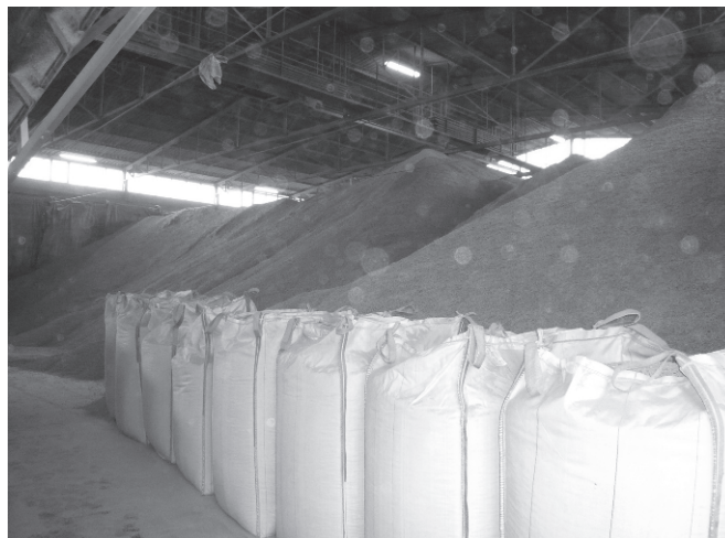
Bild 3. Lagerung von Holzpellets in loser Schüttung sowie als Sackware in Big Bags.
