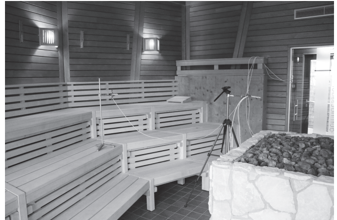
Bild 3. Messstellen: Person (Atembereich Aufgießer) und Bank.
