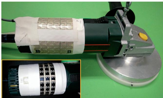
**Bild 8** Sensormontage am Winkelschleifer. Der Foliensensor liegt unter dem kapazitiven System.
