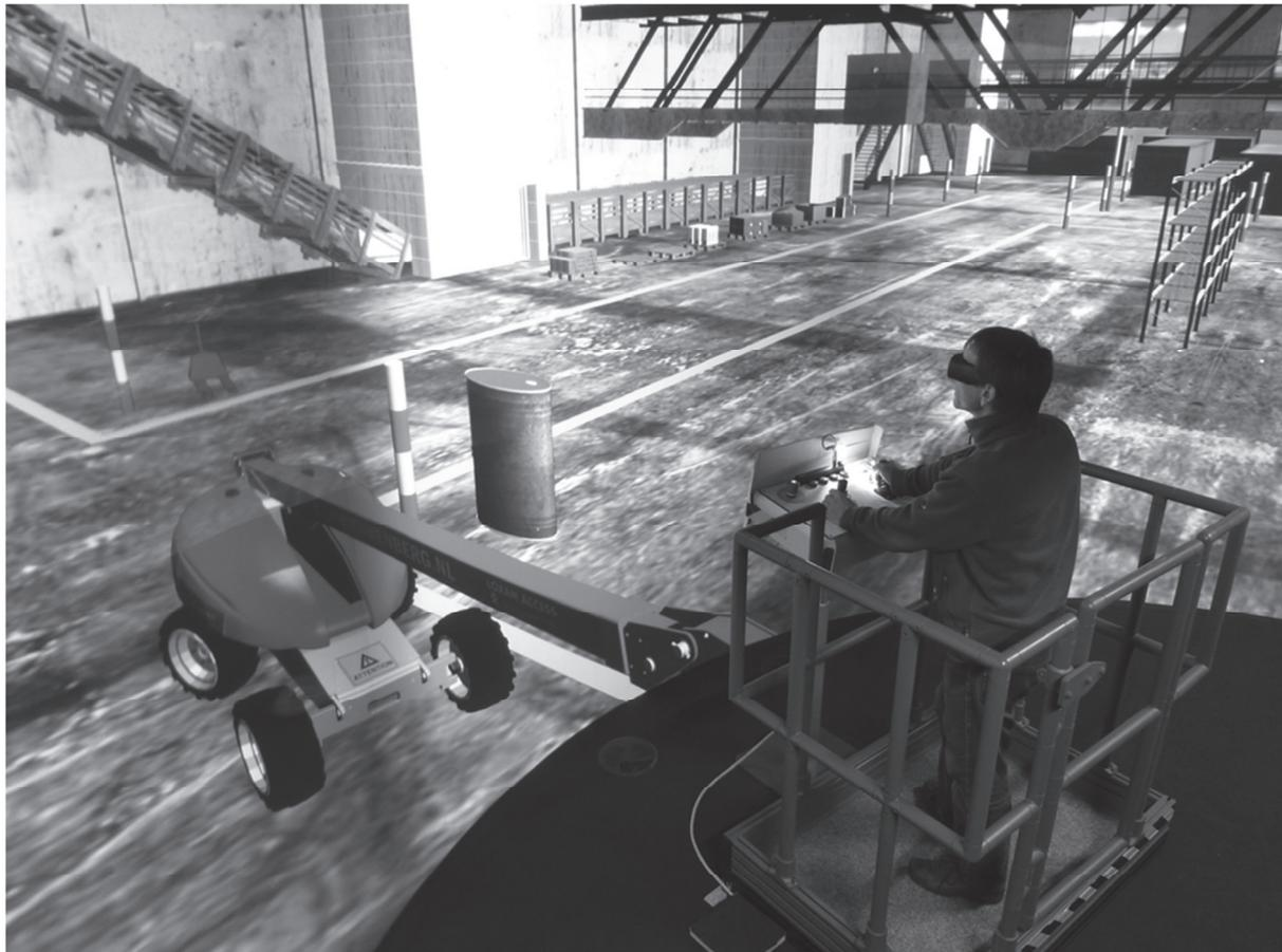
**Abbildung 1:** Gemischte Realität für die Versuche zum sicheren Führen von HAB im SUTAVE-Labor des IFA (Foto: © Lungfiel/IFA).
