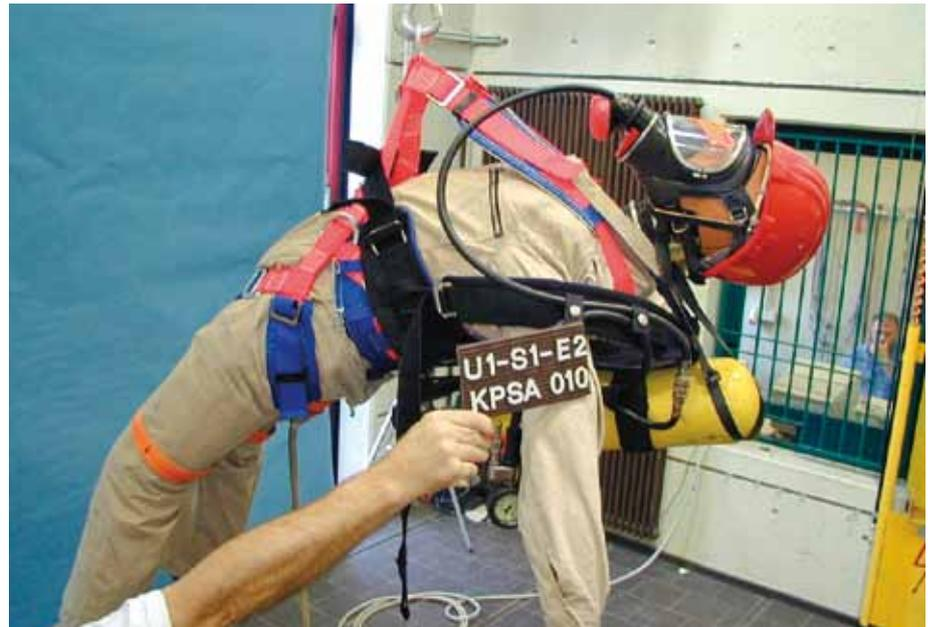
Bild 2: Untersuchung der Wechselwirkung von PSA-Kombinationen: Schutzhelm, Pressluftatmer und PSA gegen Absturz.
