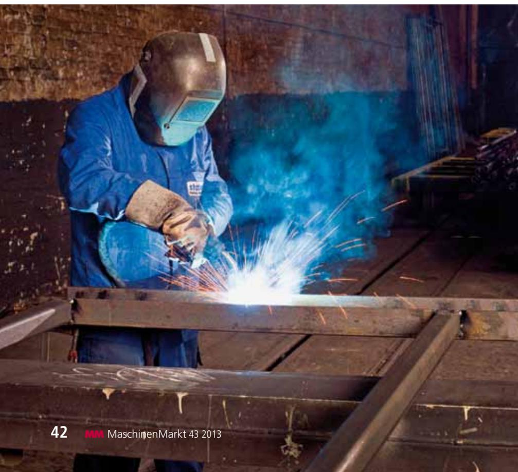
**Bild 1: Beim Schweißen sind hochwertige persönliche Schutzausrüstungen unerlässlich: zum Schutz der Augen und der Haut vor Strahlung und zum Schutz der Hände sowie weiterer Körperpartien vor Schnitten und Verbrennungen.**
