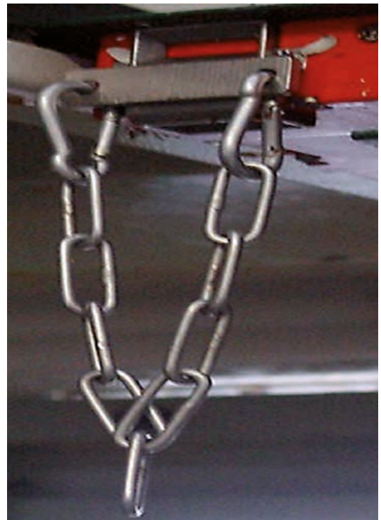
Abb. 4 Manipulierter Positionsschalter – abgeschraubter Betätiger eingesteckt und mit Kette versehen (© DGUV)
