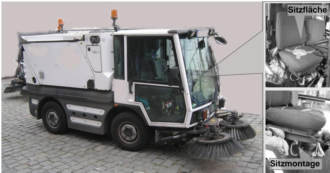
Bild 3: Die Anbringung der Beschleunigungsaufnehmer für die Ganzkörper-Vibrationen
