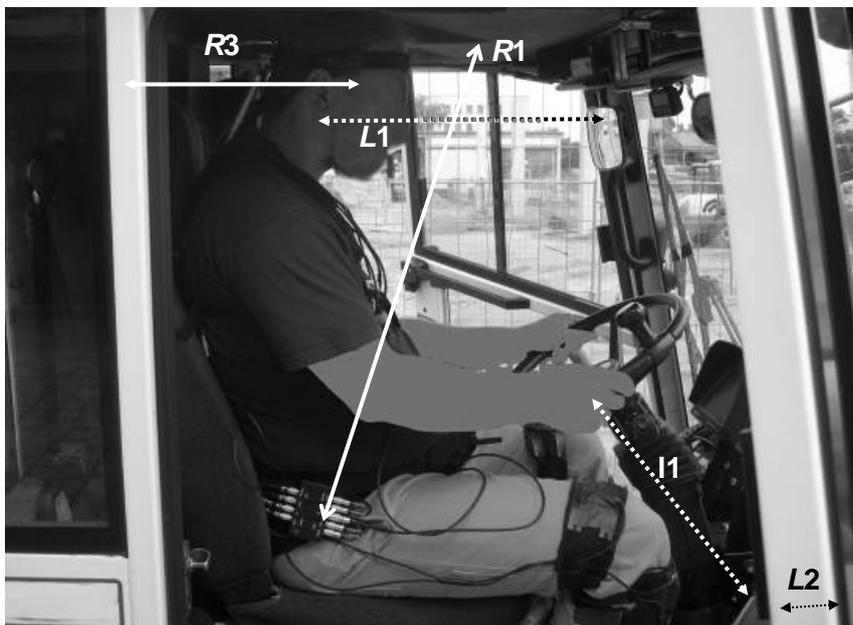
Bild 4: Mindest-Freiraummaße für den Kehrfahrzeugführer
