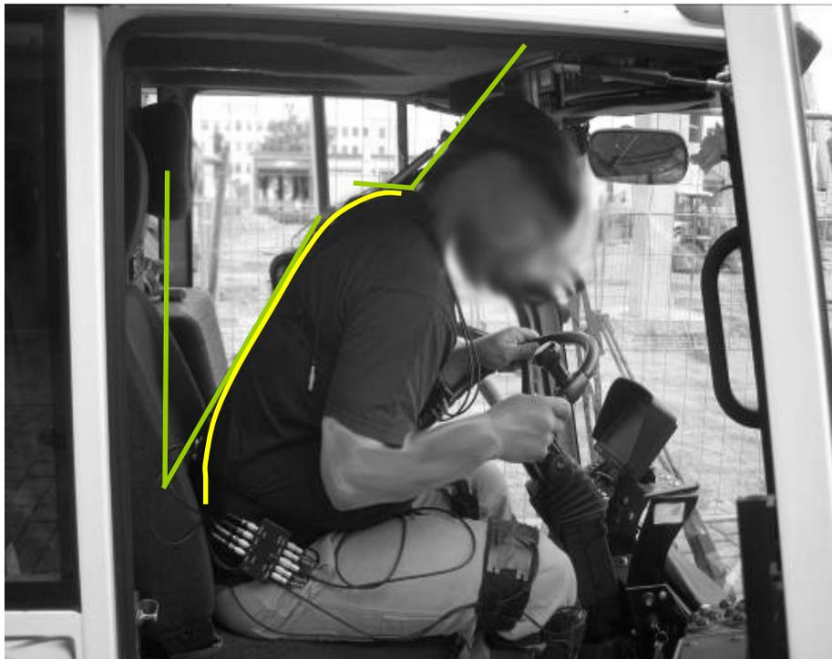
Bild 6: Eine typische Körperhaltung des Kehrfahrzeugführers während des Kehrens, die gekennzeichneten Winkel stellen die nicht-neutrale Körperwinkel dar.
