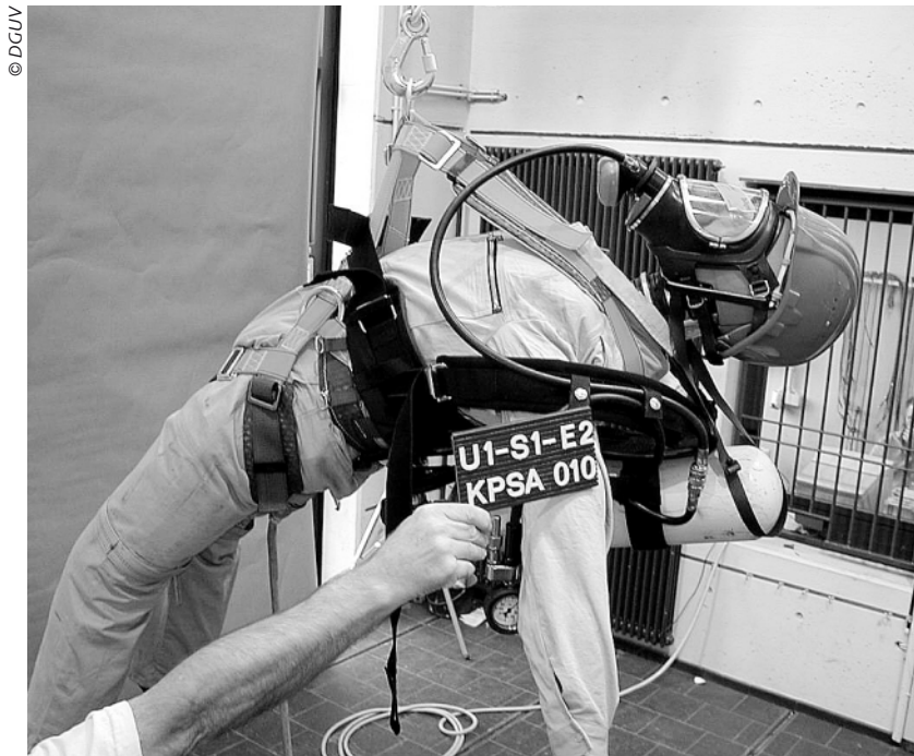
Abb. 2: Untersuchung der Wechselwirkung von PSA-Kombinationen: Schutzhelm, Pressluftatmer und PSA gegen Absturz
