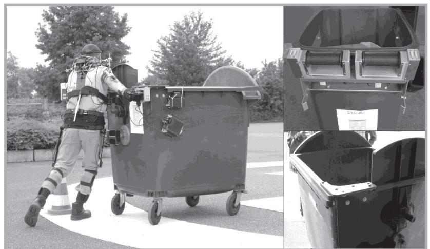
Bild 1: Messsystem zur computerunterstützten Erfassung und Langzeitanalyse (CUELA) zum Bestimmen der Rumpfhaltungen (l.) und Befestigung der eingesetzten Kraftmessgriffe zum Erfassen der Aktionskräfte (r.)
