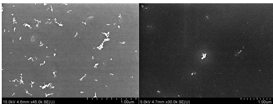
Bild 9. REM-Aufnahme von Titan- (links) und Kupferpartikeln (rechts), erzeugt mittels Funkengenerator.
