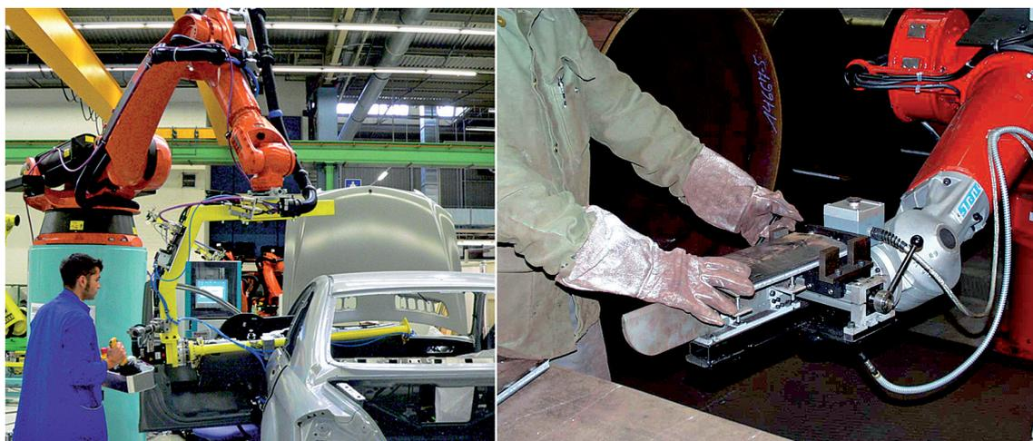
**Bild 1** Beispiele für Kollaborationstätigkeiten von Mensch und Roboter. links: bei der Armaturenmontage, rechts: als Hebe- und Positionierungshilfe beim Schweißen
