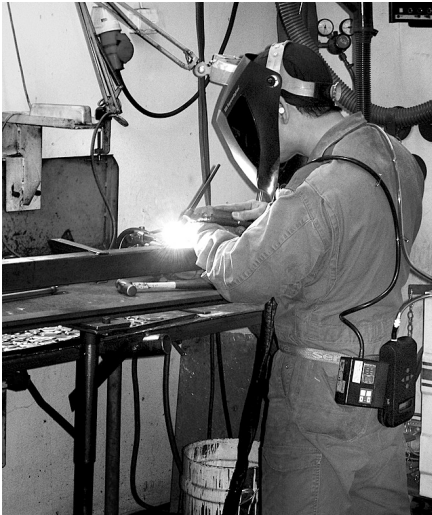
Bild 8. Einsatz eines miniDISC für Messungen an einem Schweißarbeitsplatz.
