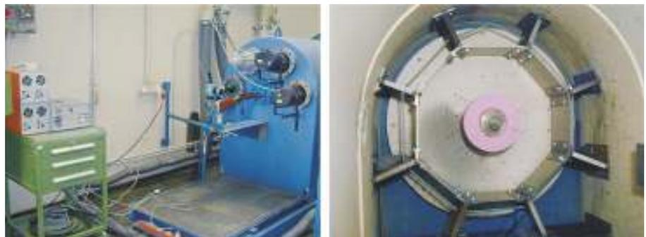
**Bild 3** Versuchsaufbau für Fliehkraftversuche.
