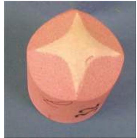
**Bild 6** Keramikprojektil (Festigkeit: 80 N/mm²) mit Stirnfläche als 90°-Pyramide mit 4 x 4 mm² Planfläche nach dem Beschuss auf Stahlblech, Geschossenergie: 1 381 J.
