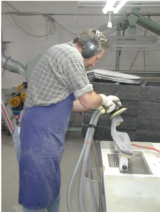
Bild 1: Vibrationsmessung beim Schleifen einer Pkw-Dekorleiste mit einem pneumatischen Excenterschleifer in einem Mitgliedsbetrieb der Holz-BG
