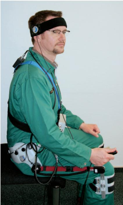
Abbildung 1: Für die hier vorgestellten Messungen verwendete Sitzversion des Körperhaltungsmesssystems CUELA.
