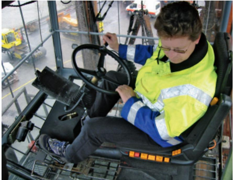
Abbildung 3: Arbeitsplatz eines Portalstapler-Fahrers.
