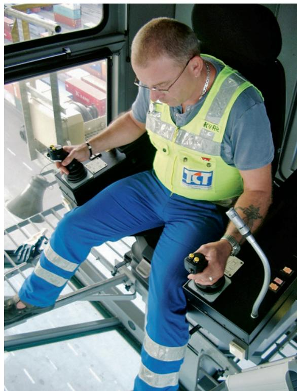
Abbildung 2: Arbeitsplatz eines Portalkran-Fahrers.
