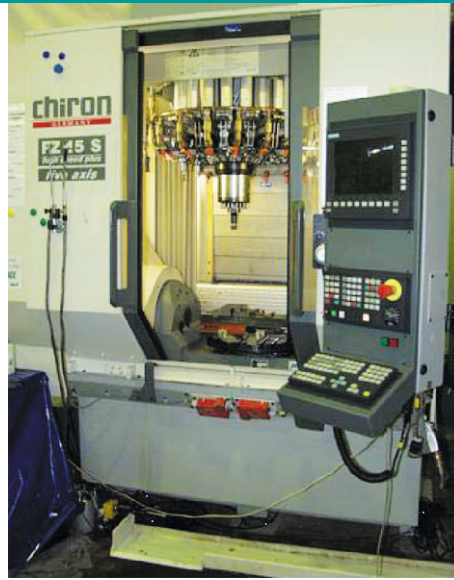
Bild 4 Eine geöffnete Fronttür ermöglicht Emissionen.
