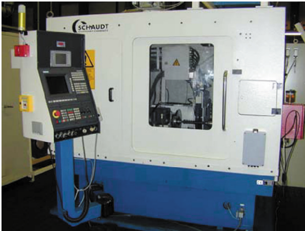
Bild 3 Beispiel für eine eingehauste Werkzeugmaschine.
