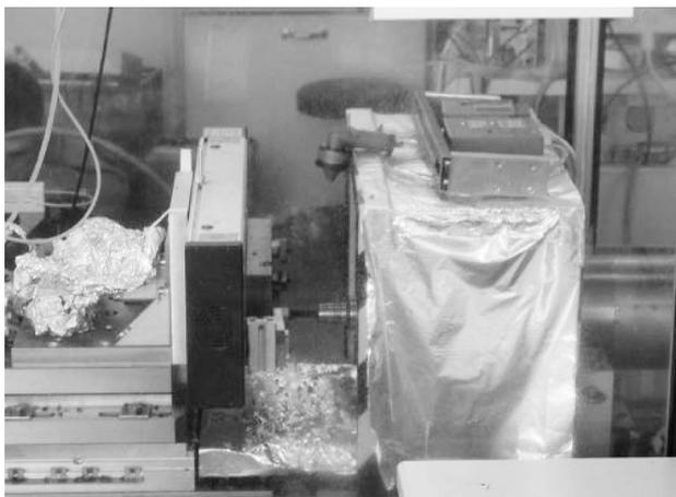
**Bild 4** Bestimmung der Emissionen an der Entstehungsstelle beim Bohren.
