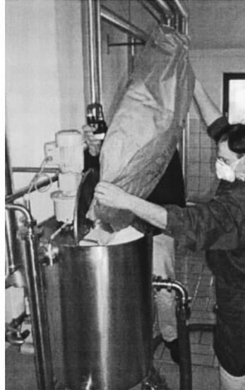
**Bild 2** Manuelles Einfüllen von Kieselgur als Sackware in das Dosiergefäß (begleitende emissionsbezogene Probenahme mit dem Staubprobenahmegerät Typ PM 4-F).
