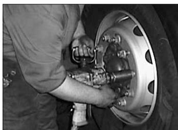
**Bild 1** | Hand-Arm-Vibrationsbelastung bei der Arbeit mit einem handgehaltenen Schlagschrauber.
