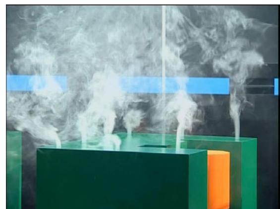
Abbildung 4: Störung des Thermikstroms bei Zuluft von der Seite (links Schema, rechts Strömungsmodell)
