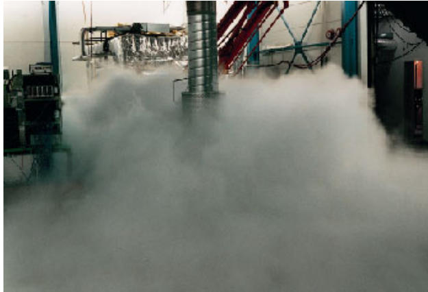
Abbildung 9: Strömungsbild an einem Quellluftdurchlass
