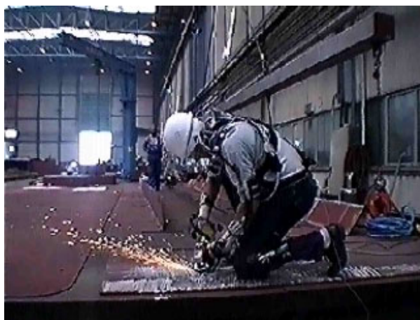
Abbildung 1: Schweißnahtvorbereitung mit Winkelschleifer
